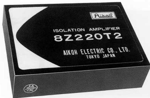
8Z-220T2の特長は入力部に安定化された電源出力( ±15V、±5mA )を持ち、出力部は出力端子と電源端子のみとして出力及びコモン間の距離を大きくして信号を送り出すシステムに使用し易くしております。そのため回路構成は定電流形アンプの8A-120Tと同一構成となっており、負荷抵抗500 Ωまでのドライブが可能となっております。
