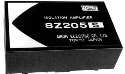
絶縁アンプは2段複合アンプで一般的に電圧出力形の絶縁アンプの場合、入力部、出力部の双方で利得のプログラムを行うことが出来ますが、温度ドリフト、リップル等を考慮して原則的に入力例で大きく利得を調整します。本器入力アンプ(A<sub>1</sub>)には低ドリフト、低オフセットのOP(μPC254A)が使用されており微小信号に対して大きな利得を設定することが出来ます。〔図5.1〕は本器の基本接続である。伝送比をKとしたとき入力e<sub>i</sub>と出力E<sub>0</sub>の関係は
